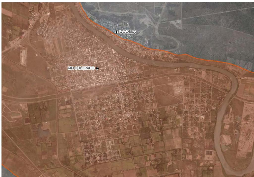
**Figura 22: Áreas de inundación por Rotura de Presa Huelches en Río Colorado - La Adela**
